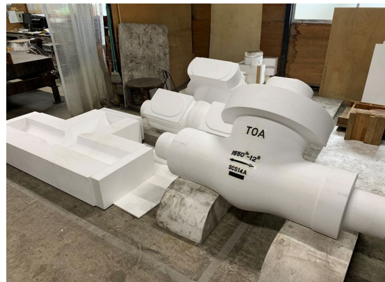
図製作したクラス1500 12B SCS14A 原子力向け仕切弁用発泡型 (鋳型・中子型・押し湯型)
