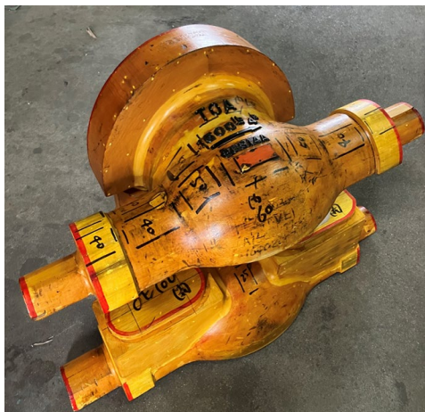
従来の木型と新規導入した発泡型による鋳型比較 (クラス1500 12B SCS14A 原子力向け仕切弁用)
